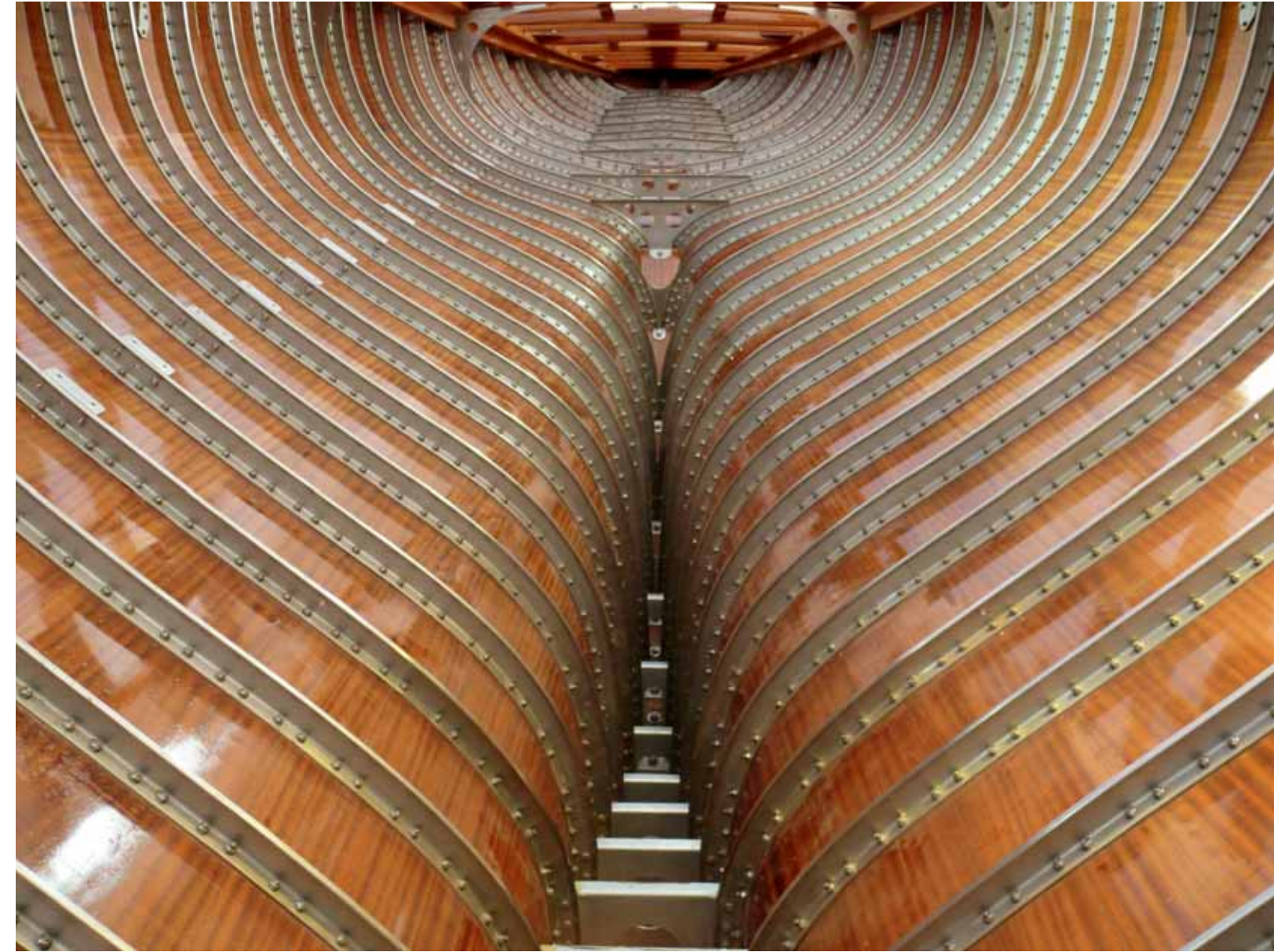
Was hier glänzt ist nicht Silber. Der fast 22 Meter lange Rumpf aus Mahagoni wird von 53 Spantenpaaren aus Stahl gehalten. Die Schönheit der Linien und die technische Perfektion machen diesen Anblick zu einem ästhetischen Genuss.
